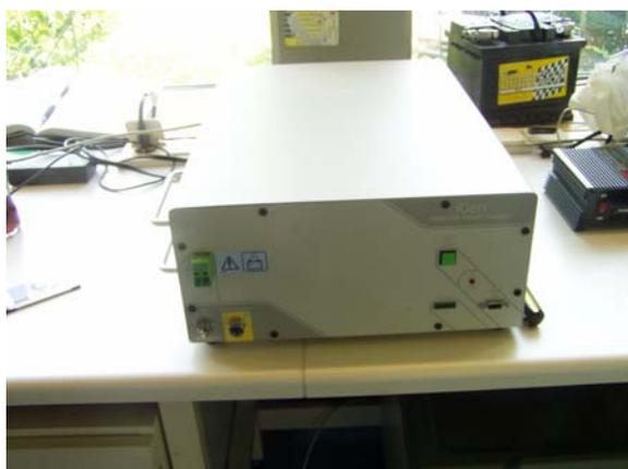
Dieses sehr kompakte BZ System besteht im Wesentlichen aus einem Reformer, der aus einem Methanol / Wassergemisch reinen Wasserstoff erzeugt und einem PEM Brennstoffzellenstapel, dem der Wasserstoff zugeführt wird. Aus dem Wasserstoff wird in den Brennstoffzellen durch eine elektrochemische Reaktion elektrische Energie und reines Wasser erzeugt.
