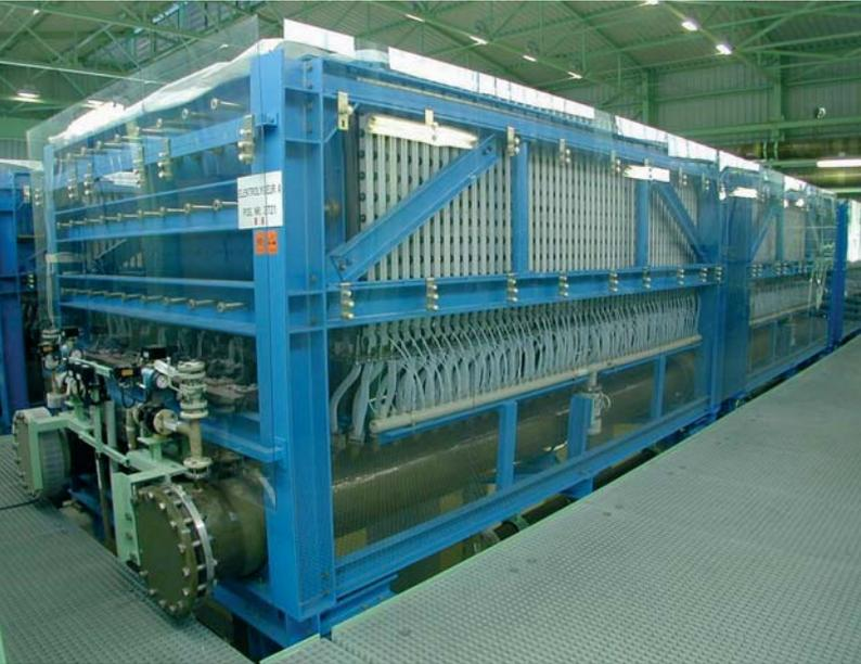
**Abbildung 2.7:** Chlor-Alkali-Elektrolyse in Hürth-Knapsack (310.000 t Chlor pro Jahr, 203.000 Nm<sup>3</sup> Wasserstoff pro Tag;  $2 \text{ NaCl} + 2 \text{ H}_2\text{O} \Rightarrow 2 \text{ NaOH} + \text{Cl}_2 + \text{H}_2$ )
