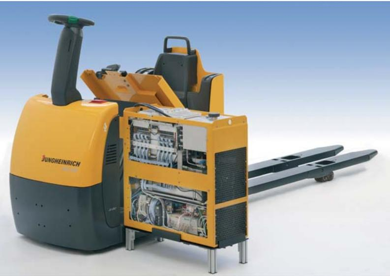
**Abbildung 4.23:** Horizontal-Kommissionierer ECE 220 mit DMFC-Energiesystem DMFC V3.1
