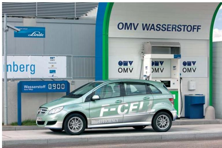
**Abbildung 4.18:** Mercedes Benz B-Klasse F-Cell (80-kW-PEM-Brennstoffzelle, 100-kW-Elektroantrieb, Li-Ion-Batterie für 30- kW-Leistung, 400 km Reichweite, Druckwasserstoff-Speicher (700 bar), Verbrauch 103 MJ/100 km oder 2,9 l Diesel-Äquivalent pro 100 km)
