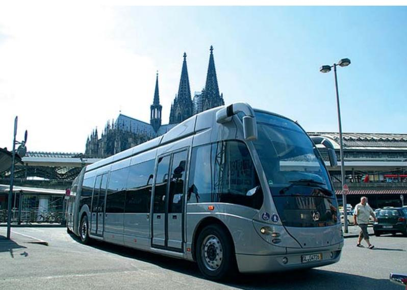
**Abbildung 4.21:** Brennstoffzellen-Gelenkbus mit Triple-Hybrid-Antrieb (240 kW Antriebsleistung)
