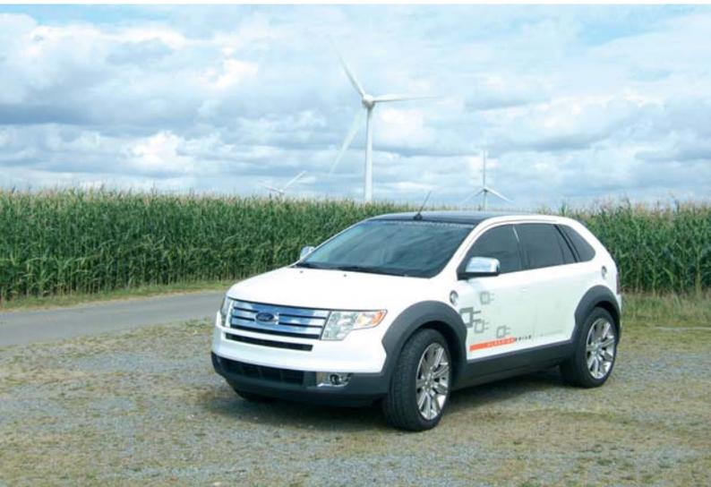
**Abbildung 4.17:** Ford HySeries Edge: Plug-In-Pkw mit Batterie, Brennstoffzellen als "Range Extender" und Druckwasserstoff-Speicher (4,5 kg, 350 bar)
