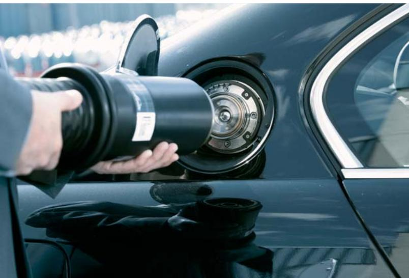
**Abbildung 3.8:** Flüssigwasserstoff-Tankkupplung
