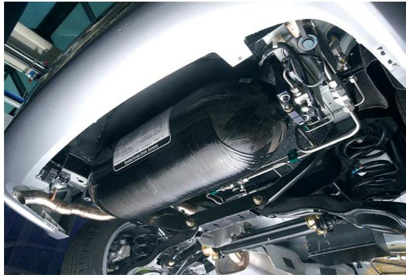
**Abbildung 4.15:** Ford-Pkw C-MAX H<sub>2</sub>ICE mit Verbrennungsmotor und Druckwasserstoff-Speicher (700 bar)
