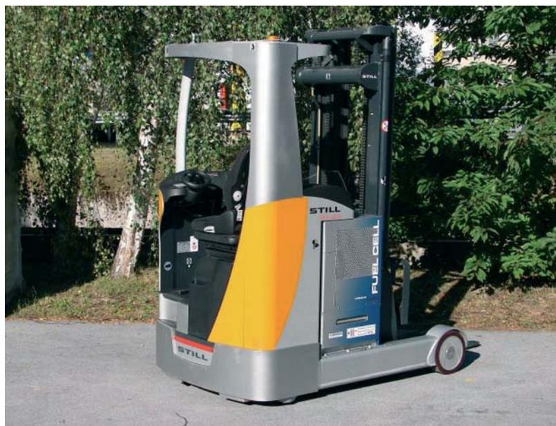
**Abbildung 4.22:** Lagertechnik-Stapler vom Typ FM20 Still
