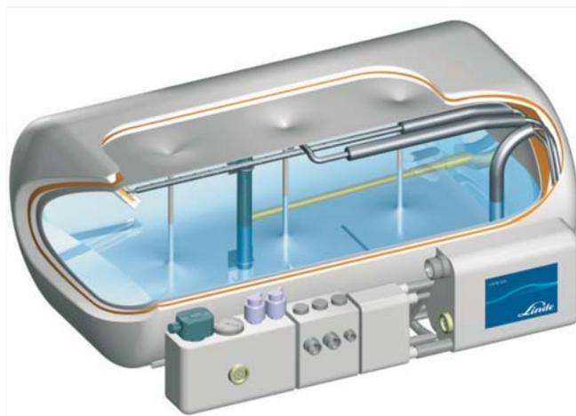
**Abbildung 3.7:** Schnitt durch einen Flüssigwasserstoffspeicher
