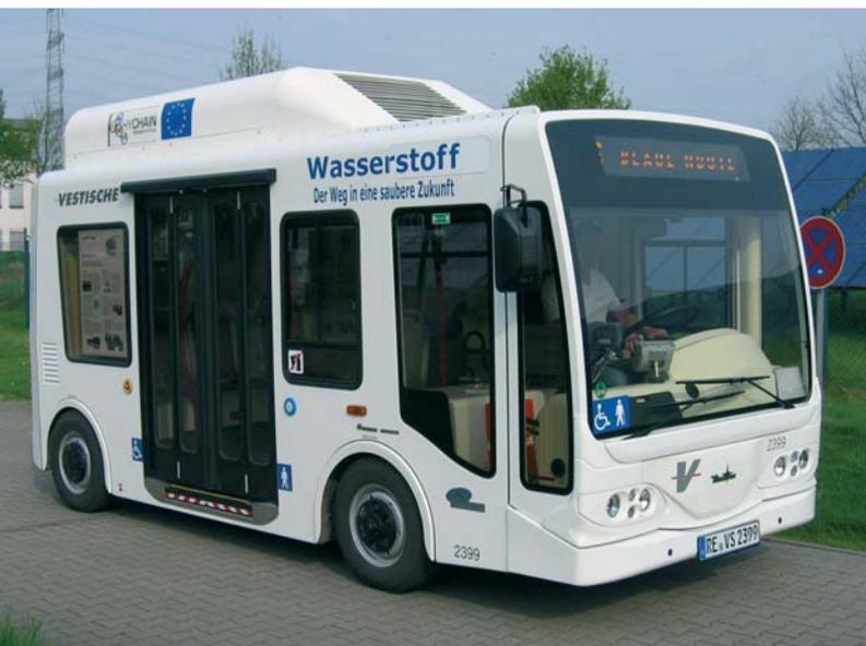
**Abbildung 4.20:** Mini-Brennstoffzellenbus
