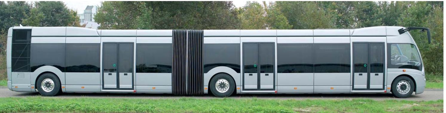
Brennstoffzellen-Gelenkbus mit Triple-Hybrid-Antrieb
