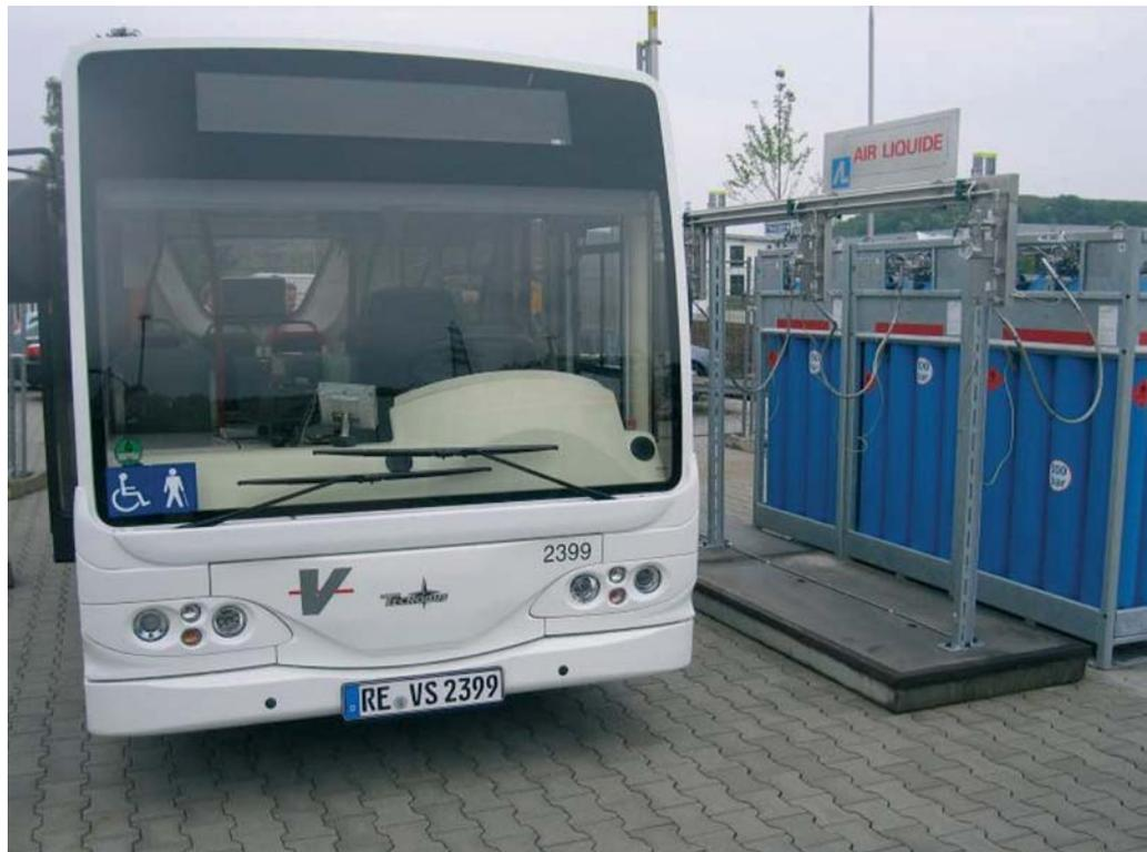
Brennstoffzellen-Midibus an der H<sub>2</sub>-Tankstelle in Herten
